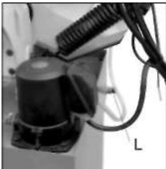
При помощи торцового ключа снимите заглушку (L) (не показана), чтобы слить хладагент.
