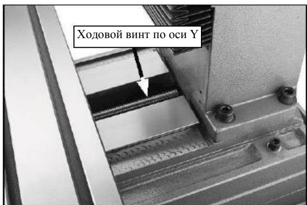
Рисунок 32. Ходовой винт для перемещения по оси Y.
