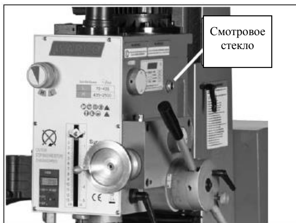
Рисунок 25. Смотровое стекло шпиндельной бабки
