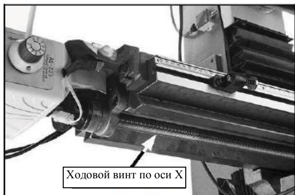
Рисунок 31. Ходовой винт для перемещения по оси X.
