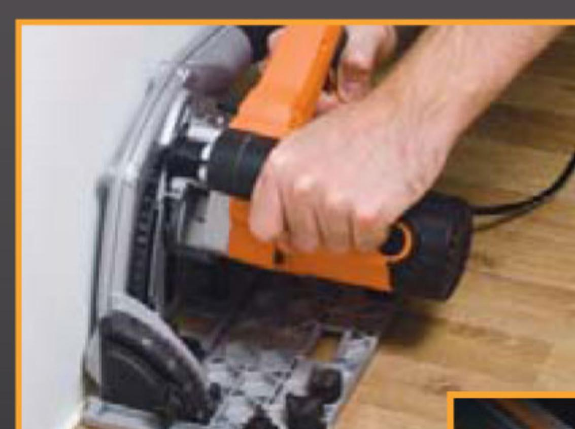
Компактная конструкция позволяет сделать пропил на расстоянии 15 мм от препятствия
