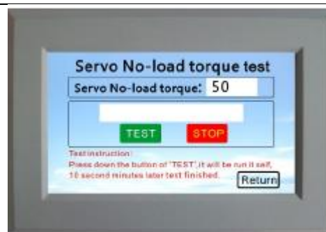
Рисунок 5. Тестирование крутящего момента сервопривода без нагрузки
