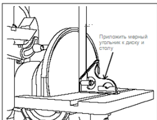
Рис. 15: Использование угольника для проверки угла.
